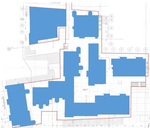
Figuur 34: Originele plattegrondtekening van de dekvloer (1850+) met aanpassingen. De rode lijn geeft de contour van het verhoogde dek inclusief trappen weer. De blauwe vlakken zijn de woonblokken.
