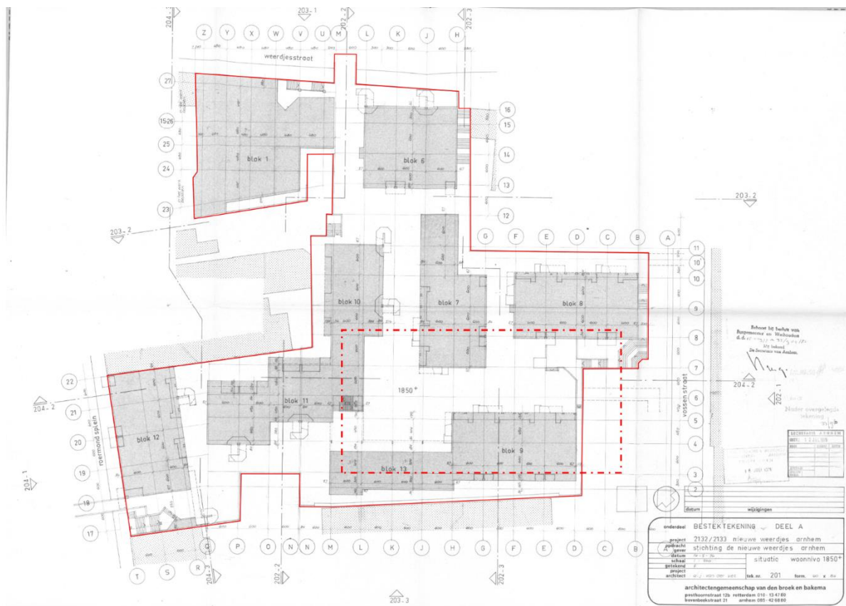
Figuur 38: Originele plattegrondtekening van het dekvloer (1850+). De rode lijn geeft de contouren van het dek weer en de rood gestippelde lijn geeft het afgebakende gebied voor dit onderzoek weer.
