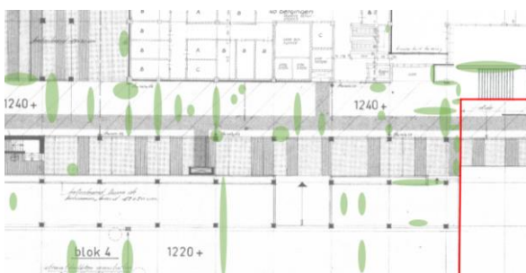
Figuur 57: Waargenomen lekkages in de parkeergarage en bergingen geïnventariseerd. De locaties zijn weergegeven in het figuur door twee samengestelde archieftekeningen (zie figuur 59 voor de legenda).
