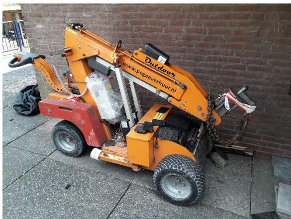
Figuur 118: Tilmachine om de grindtegels van het dek te liften.
