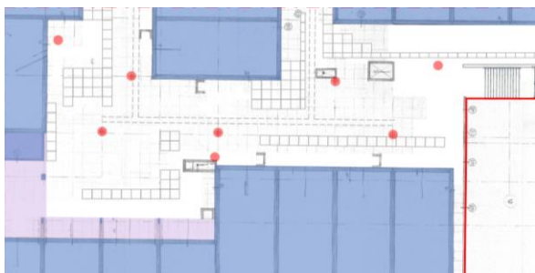
Figuur 111: Plattegrond van de kruipruimte met de opname van de huidige locaties van de hemelwaterafvoeren. Deze waren zichtbaar in de garage en geprojecteerd op de plattegrond van de kruipruimte (zie figuur 110 voor de legenda).
