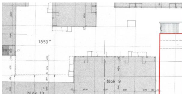
Figuur 40: Deel van de originele plattegrondtekening van het dek (1850+), aangepast naar de huidige toestand.
