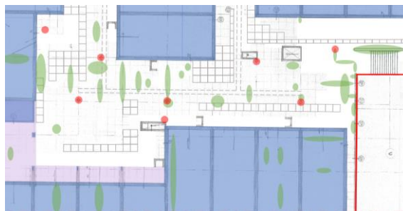
Figuur 115: Plattegrond van de kruipruimtes met de lekkages en straatkolken gemarkeerd (zie figuur 110 voor de legenda).
