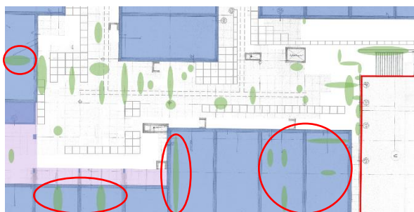
Figuur 88: Lekkages zijn geprojecteerd op de plattegrondtekening van de kruipruimte (1765+) (zie figuur 59 voor de legenda). De rode cirkels markeren de lekkages onder de woningblokken.
