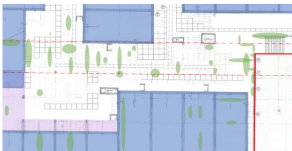
Figuur 85: Plattegrond van de kruipruimte. De groene vlekken zijn de lekkages in de kelder. Tussen de rode stippellijn zijn de prefab elementen aangebracht. De onderste lijn is as 6; boven de lijn waren de lekkages zichtbaar op de foto uit 1983 (zie figuur 59 voor de legenda).
