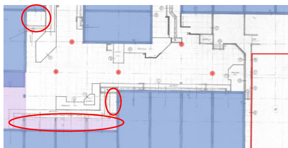
Figuur 109: Originele plattegrondtekening van de kruipruimte met markeringen van de vijf straatkolken (zie figuur 110 voor de legenda).
