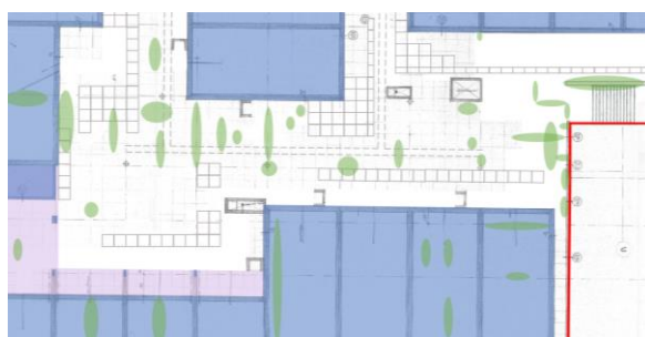
Figuur 58: Lekkages zijn geprojecteerd op de plattegrondtekening van de kruipruimte (1765+) (zie figuur 59 voor de legenda).
